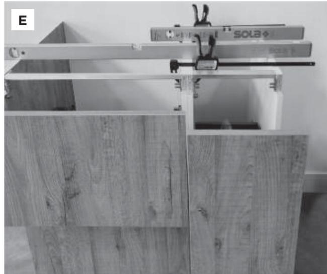
A mezzo di morsetti unire le basi e verificare nuovamente il livello tramite bolla.
