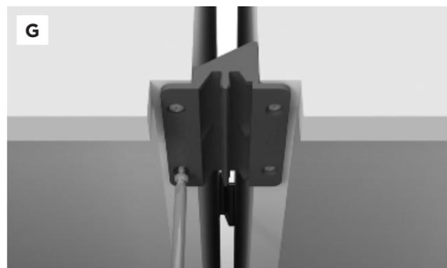
Procedere bloccando la seconda colonna avvitando il fissaggio per gole (G).
